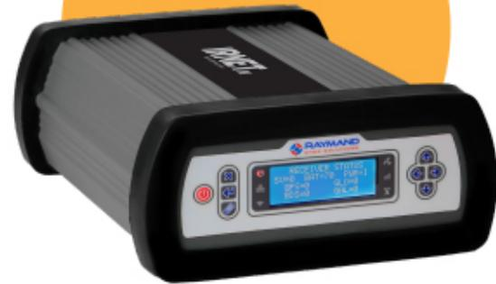
گیرنده GNSS مدل iRNet III یک ایستگاه مرجع دائمی (CORS) پیشرفته با قابلیت چندفرکانسه (Multi-Frequency) و چندمنظومه‌ای (Multi-Constellation) است که برای پایش زمین، تصحیحات RTK، شبکه‌های CORS، و مانیتورینگ دقیق تغییرات ژئودینامیکی و سازه‌ای طراحی شده است. این گیرنده با برد داخلی قابل انتخاب از میان مدل‌های Hemisphere P40 یا Septentrio mosaicX5، امکان ارائه دقت میلی‌متری را برای کاربردهای حرفه‌ای فراهم می‌کند.
