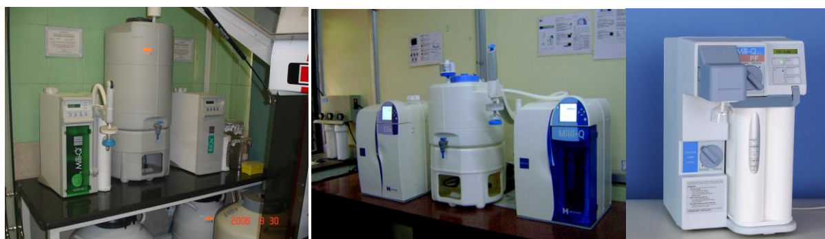
شکل ۵-۴: دستگاه Millipore-milliQ برای تخلیص آب جهت ساخت محیط‌های کشت سلولی که شکل وسط هسته مرکزی دستگاه مربوطه را می‌سازد (۲۸).
