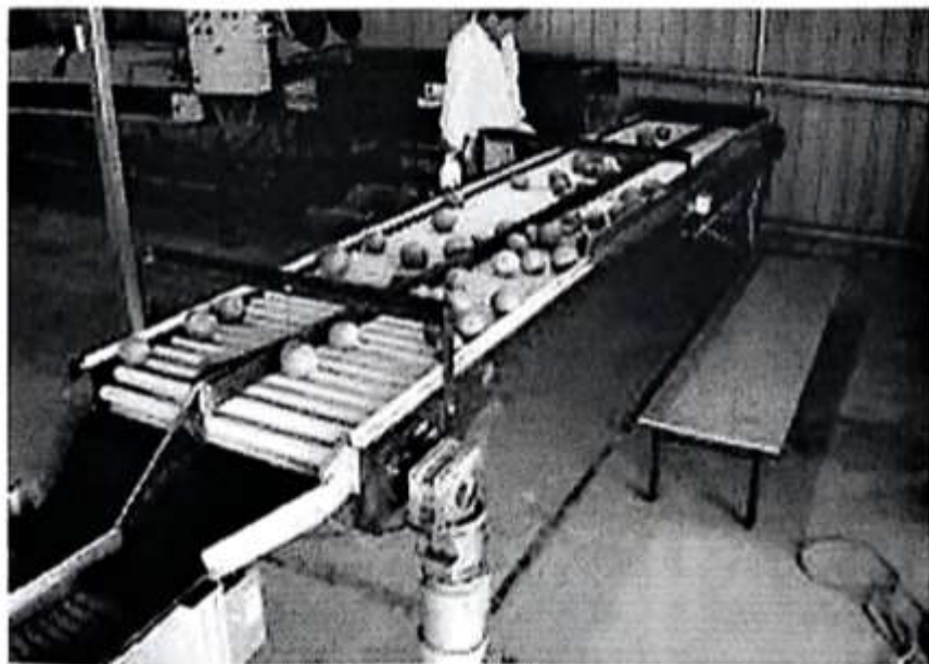
شکل ۱-۱۱ تجهیزات جداسازی میوه های خراب و مواد خارجی آغشته به آن.
