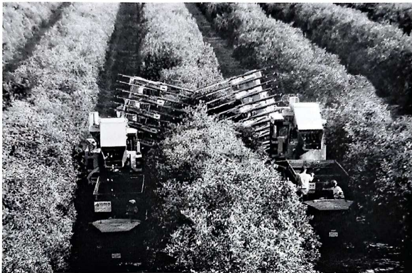
شکل ۱-۳ نمایش شاخک‌های چیدن میوه و نحوه حرکت آنها.
