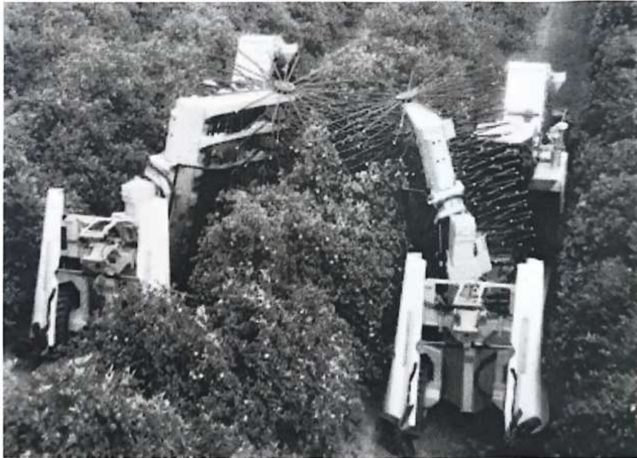
شکل ۱-۲ نحوه قرار گرفتن ماشین و شاخک‌های مربوط به چیدن میوه در کنار درخت.
