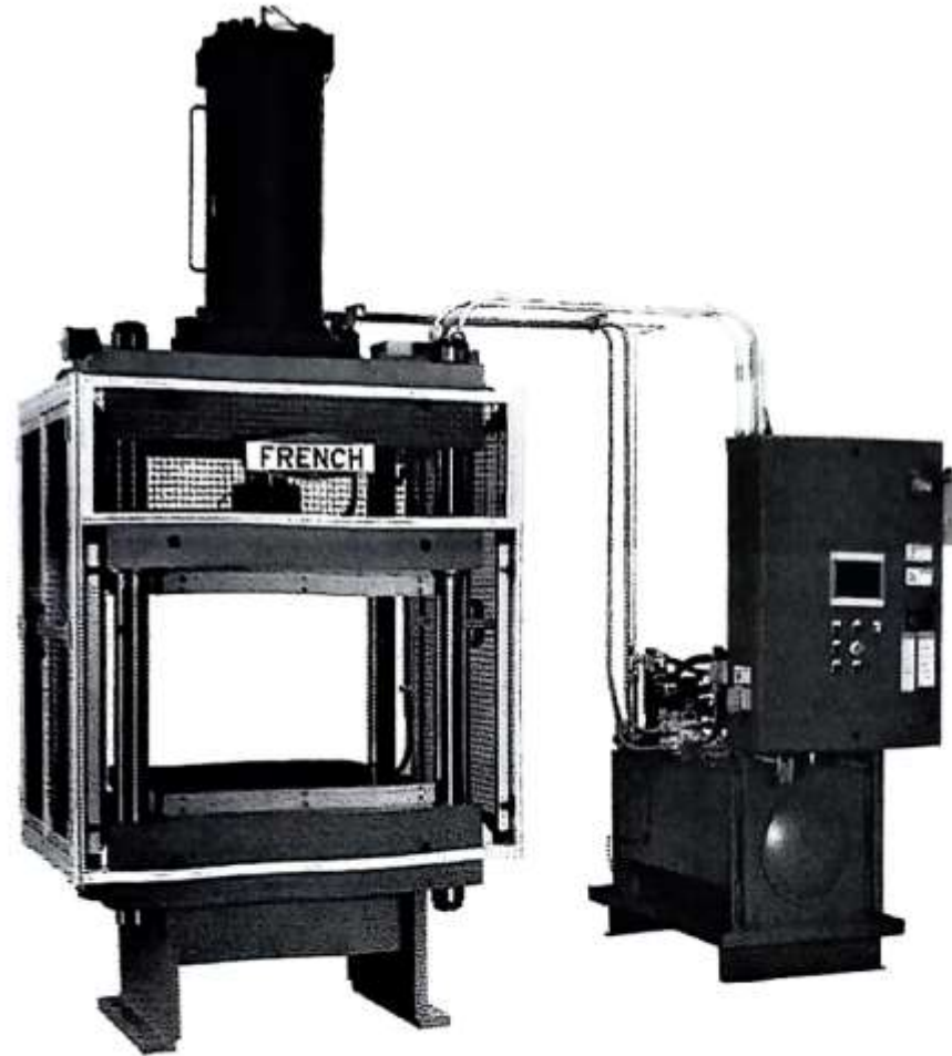
شکل ۲-۷ عصاره گیر فشاری هیدرولیکی چرخ دار با قاب.
