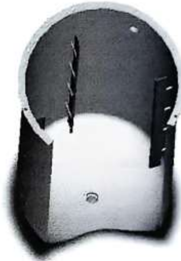
شکل ۳-۵ نمایش انواع مخازن نگهداری و نحوه استقرار همزن و انواع همزن.
