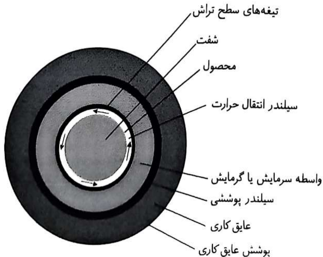
شکل ۵-۲۰ (الف) قسمت‌های مختلف مبدل حرارتی سطح تراش، (ب) قسمت‌های داخلی مبدل حرارتی سطح تراش.
