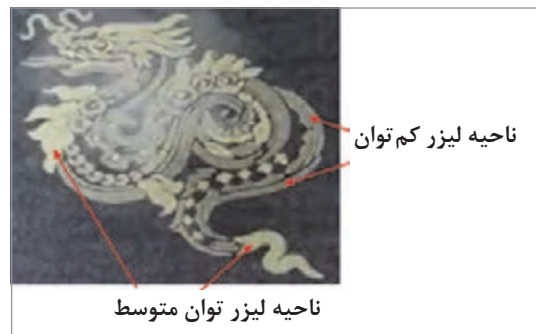
شکل ۲۹- ایجاد نقش با لیزر روی پارچه دنیم
