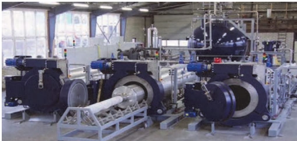
شکل ۲۵- یک نمونه ماشین رنگری فوق بحرانی CO ۲
