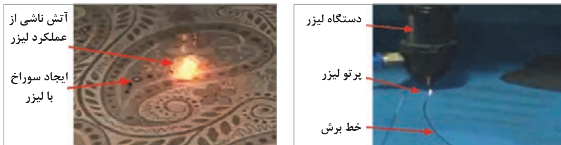
شکل ۳۰- برش لیزری پارچه با توان زیاد شکل سمت راست (الیاف مصنوعی) شکل سمت چپ (پنبه)
