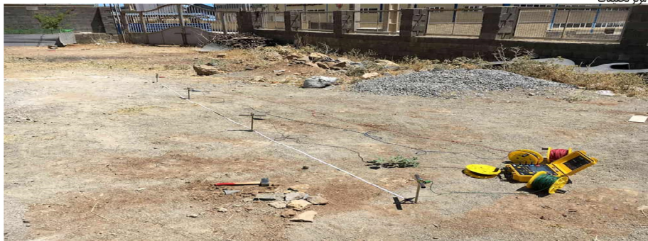
شکل ۴-۳. اندازه‌گیری مقاومت مخصوص خاک با چهار رشته سیم مجزا متصل به دستگاه تستر
