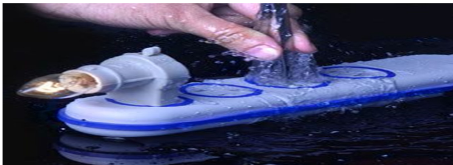
شکل ۵-۷. بروز خطر الکتریکی در اثر نشتی مایعات
