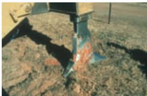
تصویر ۲۴. برهم زدن مناطق متراکم مسیر چرخ های ماشین آلات در تاجستان (Lanyon, 2011)
