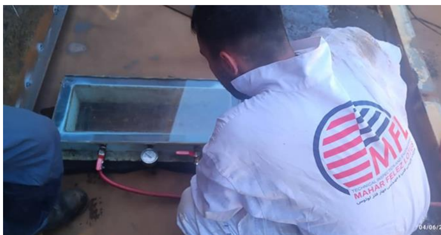
اجرای بازرسی به روش VB در پایانه نفتی خارگ
