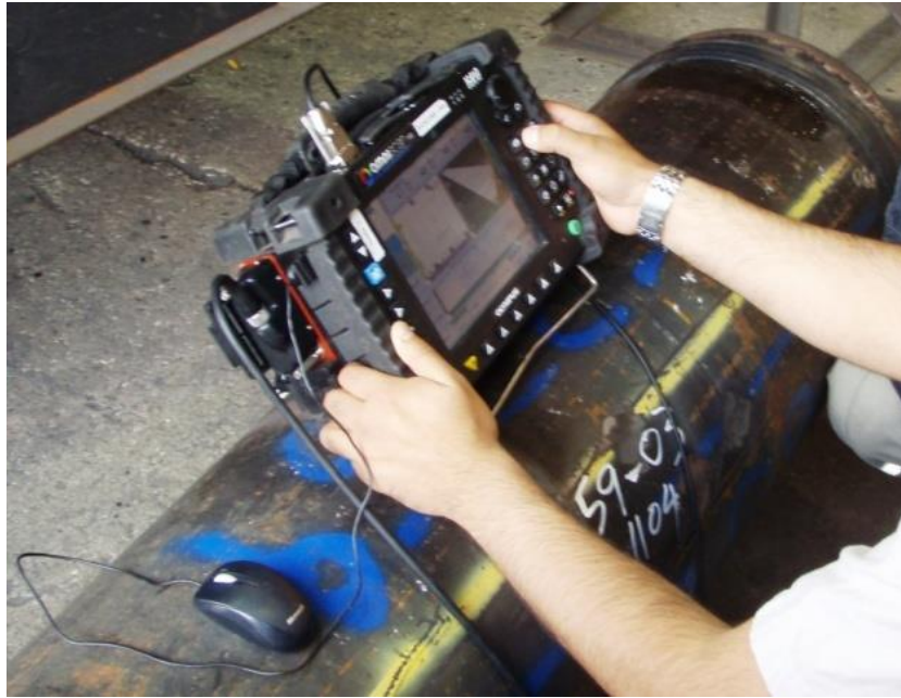
انجام بازرسی به روش PAUT در پایانه نفتی خارگ
