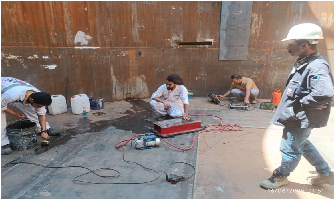
اجرای همزمان دو تیم بازرسی به روش های PAUT & VB بر روی مخزن معدن طلای کردستان
