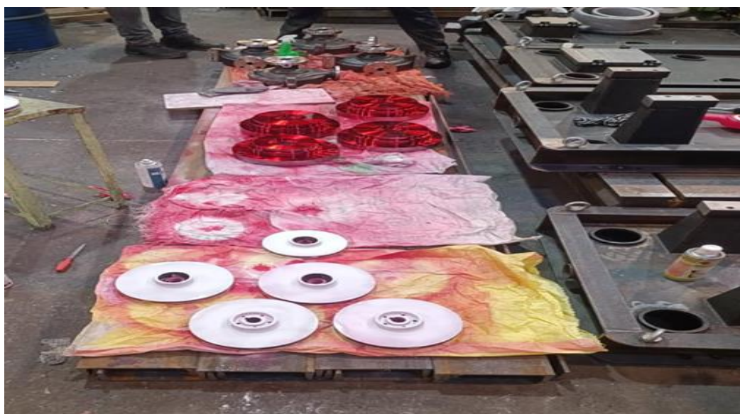
اجرای بازرسی به روش PT مربوط به نیروگاه اتمی بوشهر
