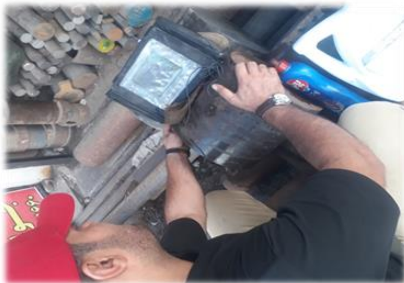
انجام بازرسی به روش التراسونیک پروژه پتروشیمی مروارید
