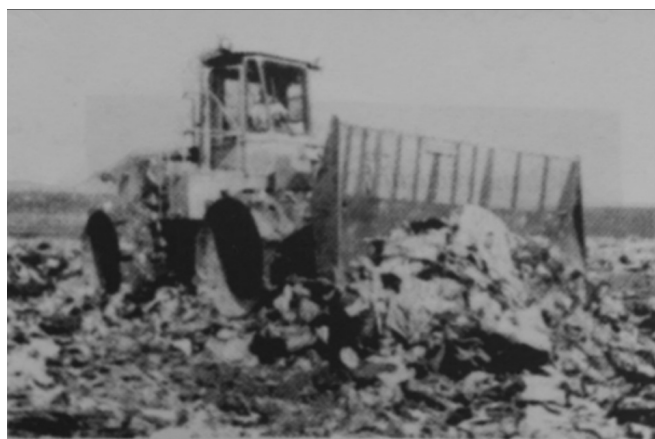
شکل ۴-۷. متراکم‌سازی پسماند در محل‌های دفن بهداشتی قبل از کاربرد پوشش روزانه
