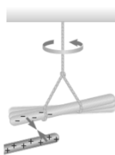
پ) وقتی میله پلاستیکی مالش داده شده با پارچه پشمی را به میله شیشه ای مالش داده شده با پارچه ابریشمی نزدیک کنیم، همدیگر را جذب می کنند.
